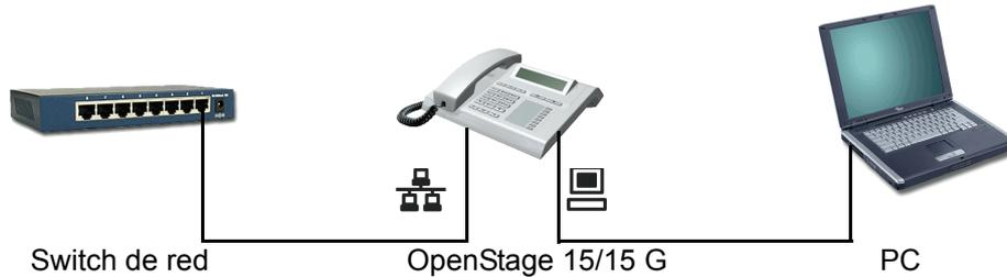
Gracias a este tipo de conexión se evita ocupar cada vez una conexión de red en el switch utilizado y, con una planificación idónea de las conexiones, se requiere menos cable de red y los trayectos de cable resultan más cortos.
